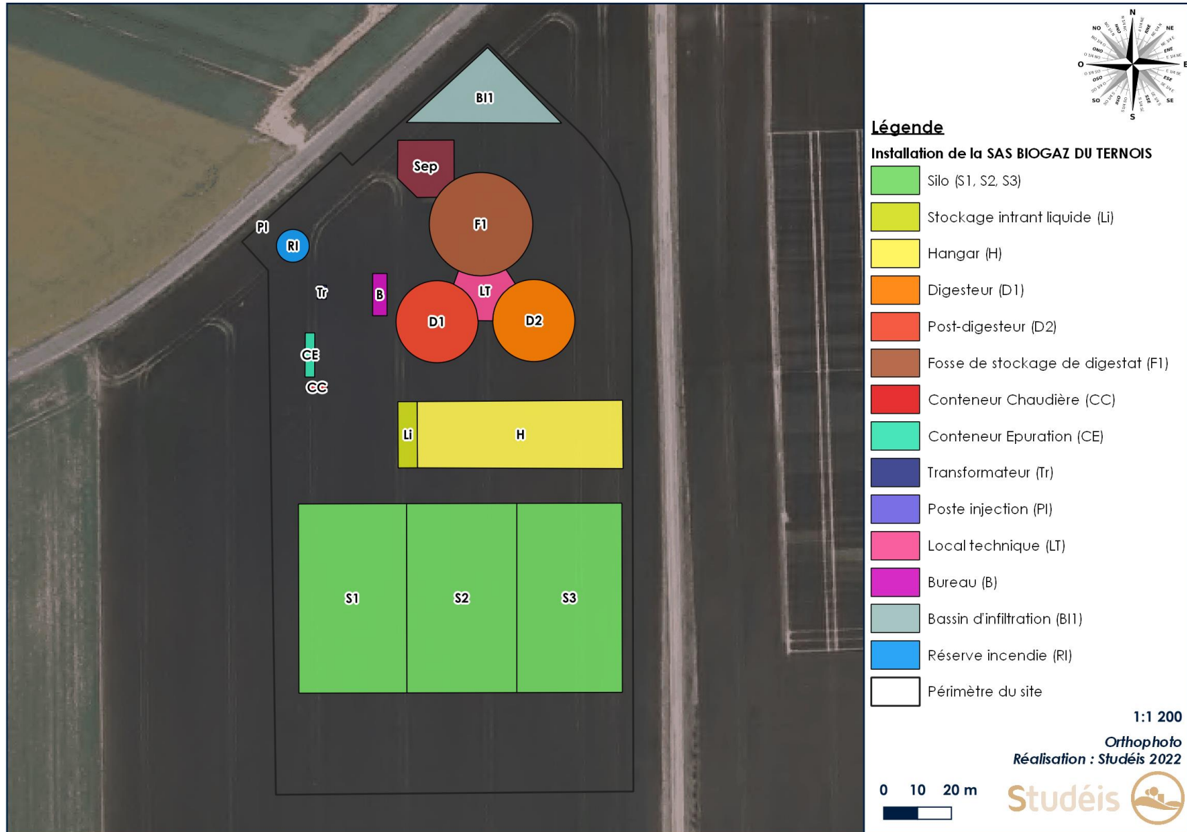
Figure 2. Agencement actuel de l'unité de méthanisation de la SAS BIOGAZ DU TERNOIS (Source : Studéis)
